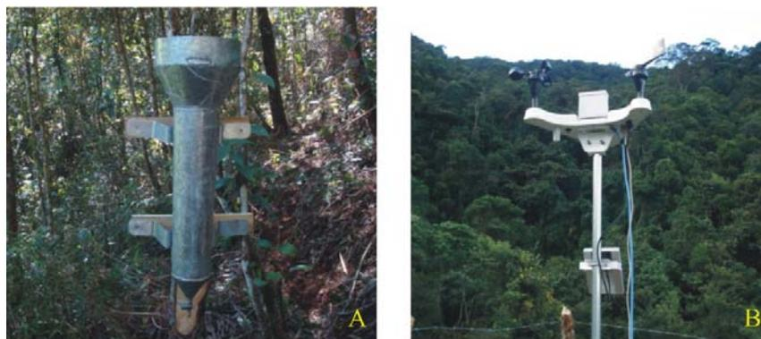
Figura 2 Pluviômetro (a) e estação meteorológica (b) empregados para o monitoramento da precipitação incidente e precipitação interna na MBMA
