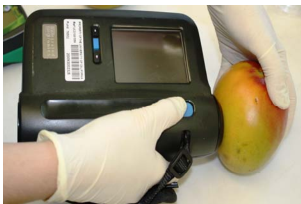
Figura 1: Equipamento com infravermelho próximo utilizado nas avaliações de conteúdo de matéria-seca em mangas durante o armazenamento.
