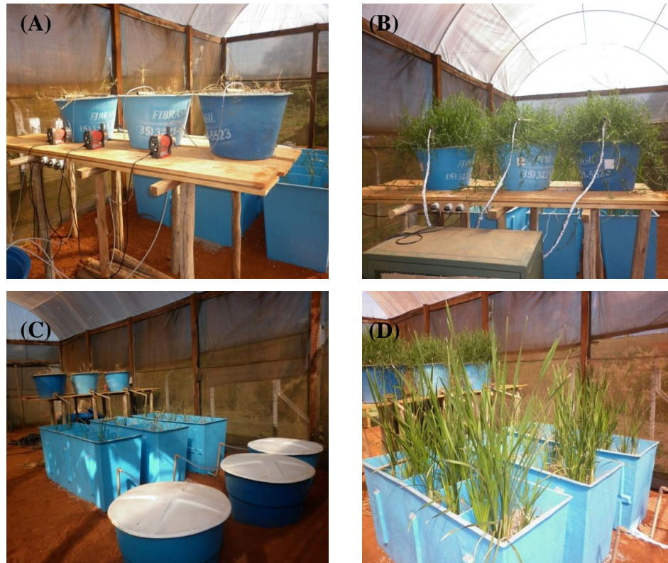
Figura 2 Sistema experimental: (A) e (B) detalhe dos sistemas verticais e (C) e (D) detalhe dos sistemas horizontais na implantação e aos 45 dias de monitoramento, respectivamente
