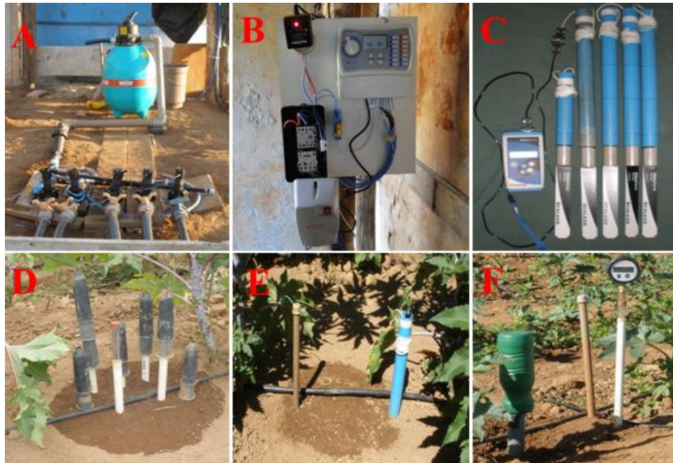
FIGURA 4 Registros, válvulas elétricas e filtro de areia (A); painel de programação da irrigação (B); sensores HidroFarm (C); bateria de tensiômetros (D); Watermark (E, à esquerda) e HidroFarm (E); tensiômetro e leitor de tensão (tensímetro) em conjunto (F, à direita). Lavras, MG, 2011.
