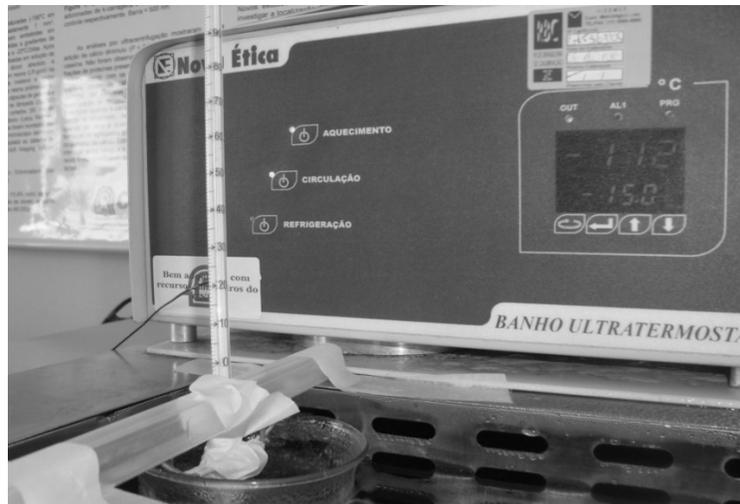
Figura 8 Aparato experimental para a determinação da temperatura de início de congelamento
