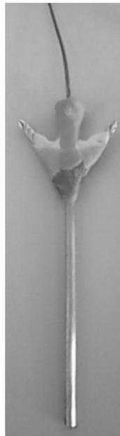
Figura 9 Sonda linear de aquecimento, construída para a determinação da condutividade térmica
