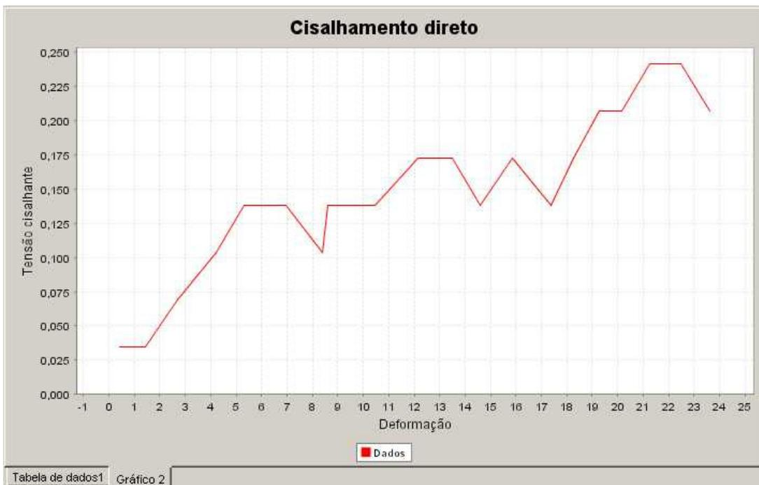
Figura A.11 – O gráfico de Cisalhamento Direto obtido da entrada dos dados da tabela ilustrada na Figura 4.7
