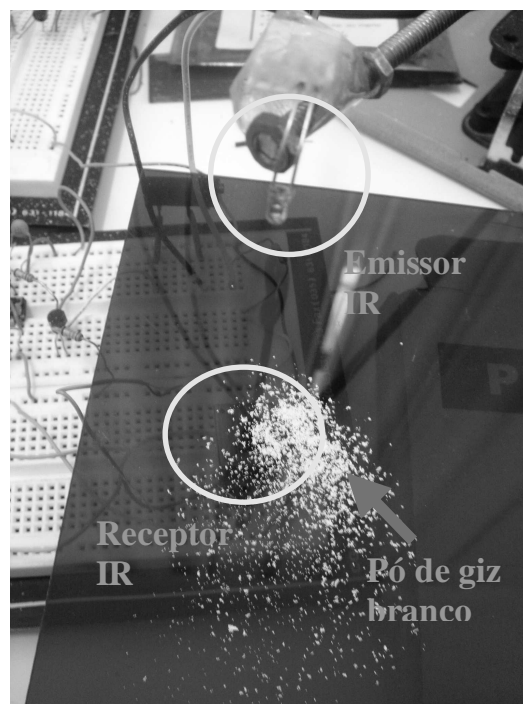
Figura 6.1: Teste do sensor usando pó de giz branco
