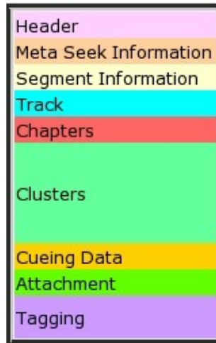
Figura 7: Representação de um arquivo Matroska (MATROSKA, 2007)
