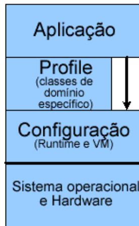
Figura 2.5: Pilha de software genérica a ser implementada por um dispositivo J2ME.
