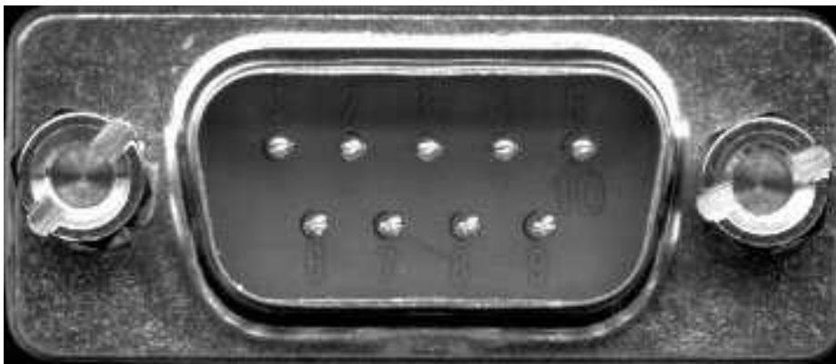
Figura 2.1: Conector DB9M – Geralmente usado em portas seriais
