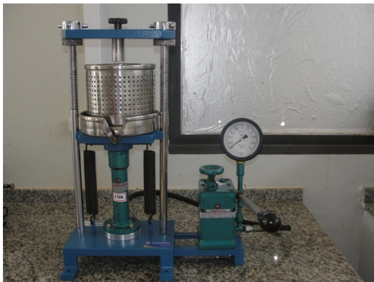
Figura 5 Peça adaptada a prensa em aço inox para a etapa de prensagem
