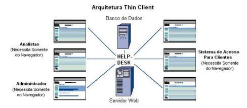
Figura 6: Arquitetura Thin Client Baseada em Web [DCC/UA, 2004].
