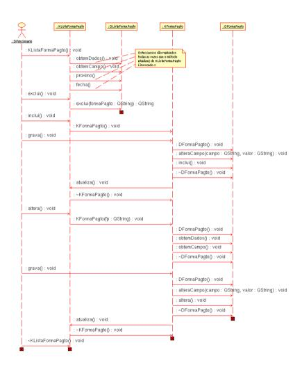
Figura 4-12. Diagrama de seqüência para o cadastro de formas de pagamento
