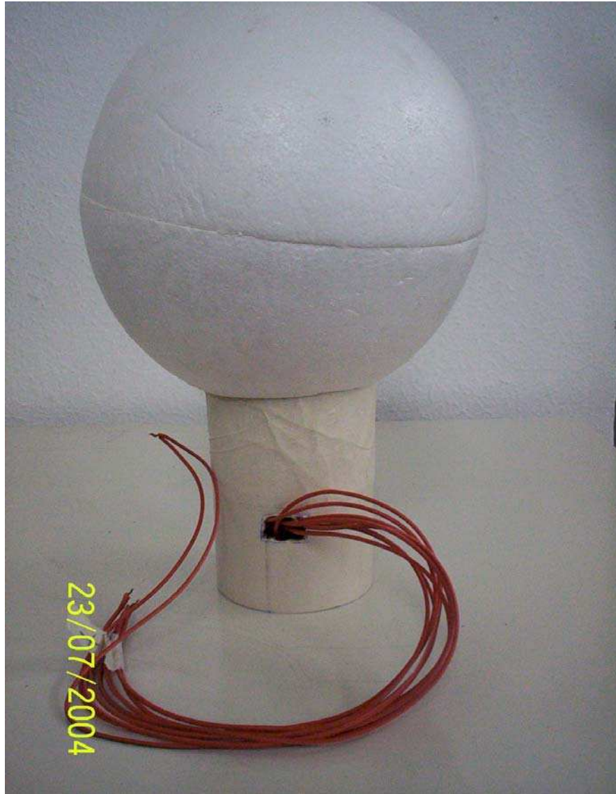
Fig. 3.2.7 : Vista traseira da montagem destacando passagem dos fios dos led's
