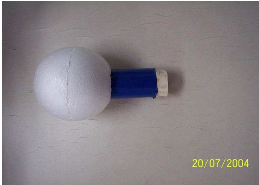
Fig. 3.1.3: Cano de pvc fixado à bola de isopor
