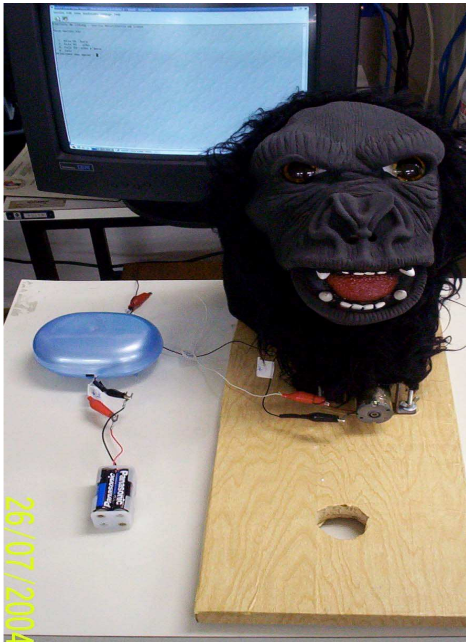
Fig. 6.4 : Projeto finalizado– animatrônico “Cabeça de Gorila” com tela do programa de controle ao fundo
