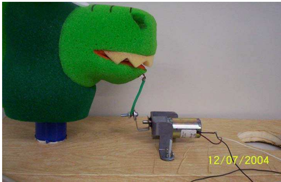
Fig. 6.2: Detalhe conexão motor-mandíbula do animatrônico “Cabeça de Dragão”
