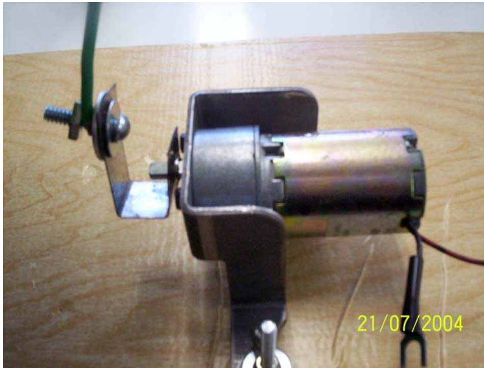
Fig. 3.1.9: Detalhe do conjunto gancho-biela-motor
