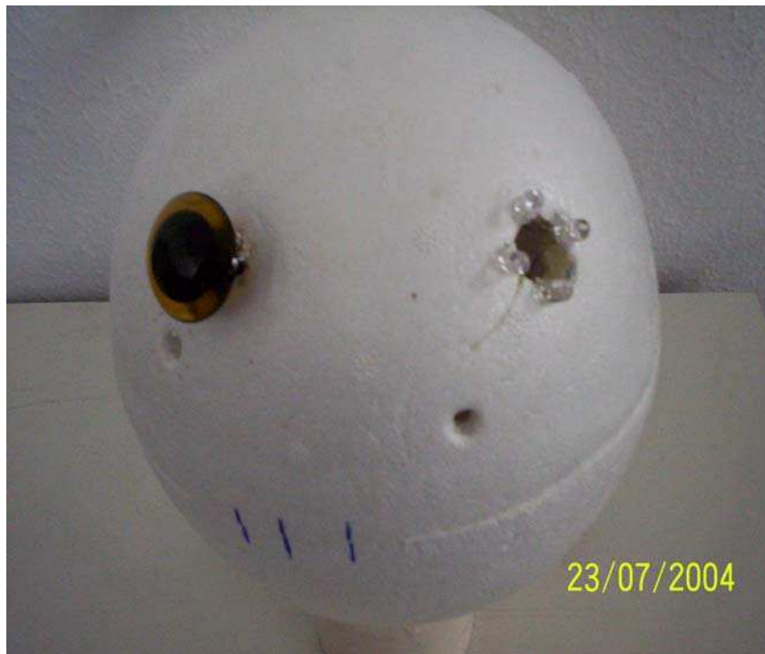
Fig. 3.2.6 : Detalhe do esqueleto com olho esquerdo colocado e led's do olho direito à mostra
