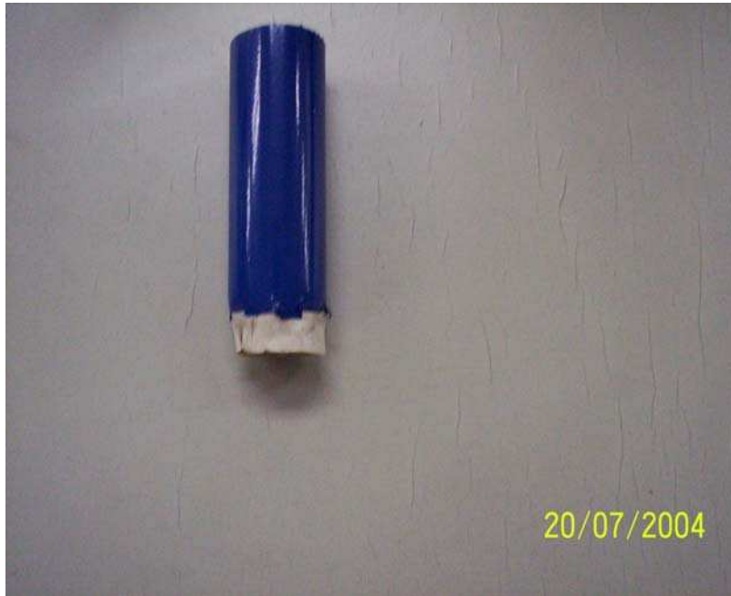
Fig. 3.1.2: Peça de cano de pvc utilizado para fixação da cabeça na base
