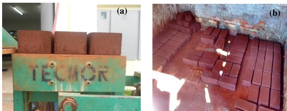
Figura 8 Tijolos de solo-cimento com inserção de resíduo da ETA/UFLA: (a) tijolos após a prensagem e retirada da prensa; (b) tijolos dispostos em local coberto para a cura
