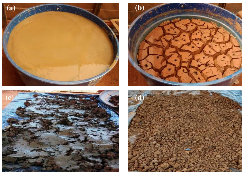
Figura 6 Diferentes etapas de desidratação do lodo adensado proveniente da ETA/UFLA: (a) camada de lodo adensado lançado no leito de secagem; (b) e (c) lodo retirado do leito e espalhado sobre superfície plástica; (d) lodo após 10 dias de secagem sobre a superfície plástica
