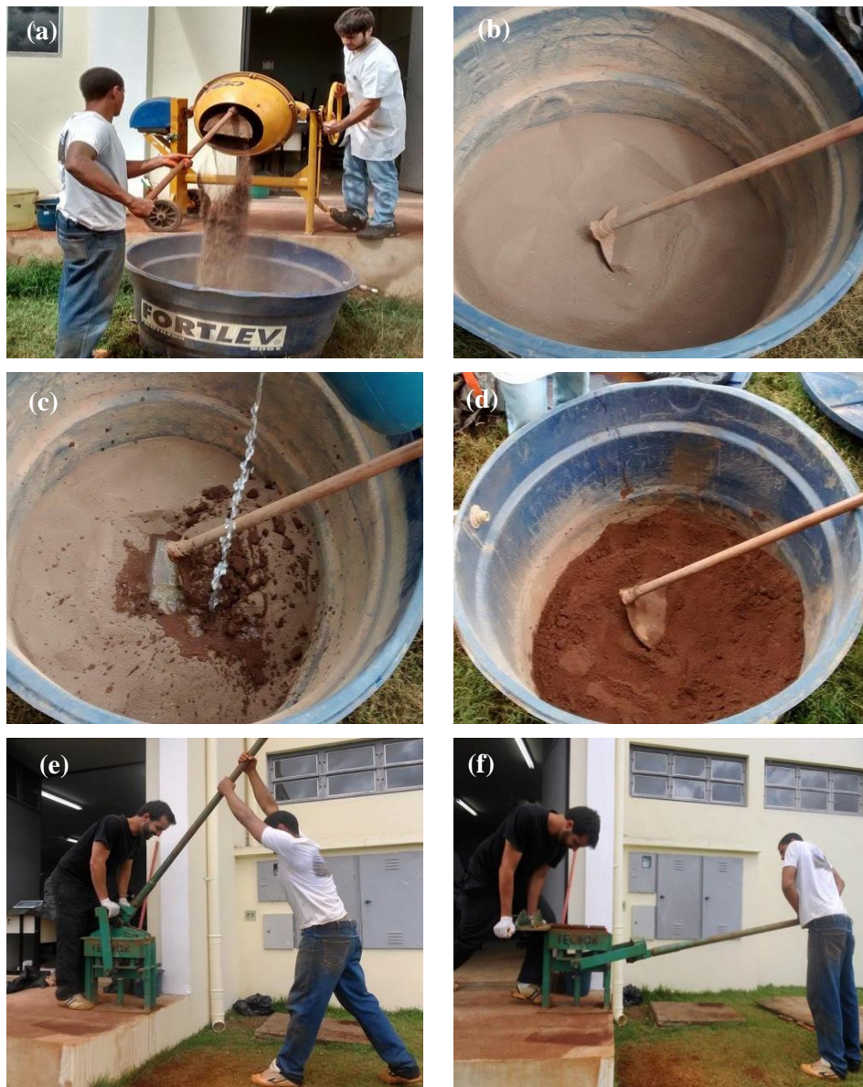
Figura 7 Etapas da confecção do tijolo de solo-cimento: (a) mistura do solo com o resíduo e o cimento com o auxílio de uma betoneira; (b) aspecto do material homogeneizado; (c) adição de água na mistura; (d) homogeneização da água na mistura com auxílio de enxada; (e) prensagem dos tijolos em prensa manual; (f) retirada dos tijolos prensados
