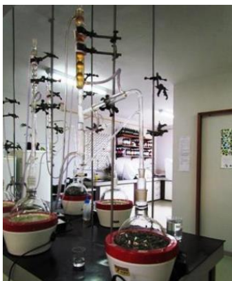
Figura 4 Processo de extração do óleo essencial (hidrodestilação)
