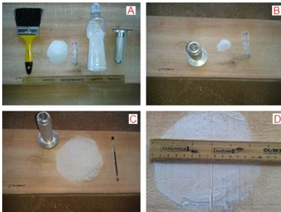
Figura 8 Etapas do método de determinação da altura das microesferas de vidro aplicada na madeira de Eucalyptus grandis . A Figura A são os materiais utilizados, a Figura B e C mostram o processo de formação da mancha de microesferas de vidro com espalhador e, na Figura D, é o demonstrativo de suas mensurações.
