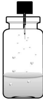
Figura 6 Esquema de extração por headspace em SPME
