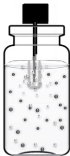
Figura 7 Esquema de extração protegida com membrana em SPME
