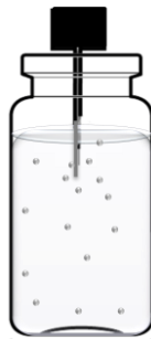
Figura 5 Esquema de extração por imersão direta em SPME
