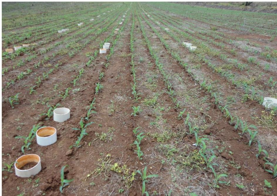
Figura 1 Bases de PVC para coleta de amônia
