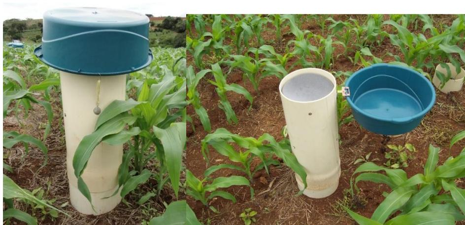
Figura 2 Câmara coletora de amônia, tipo semiaberta
