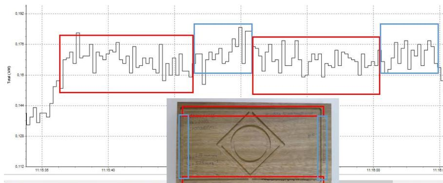
O efeito da variação da densidade aparente da madeira, para diferentes cortes, na variação da potência é citada na literatura pertinente. Contudo, não é observada a quantificação dessa interferência. Na Tabela 3, encontra-se a variação percentual do consumo da potencia ativa em diferentes padrões de velocidade de avanço e de corte, para diferentes cortes em diferentes madeiras.
