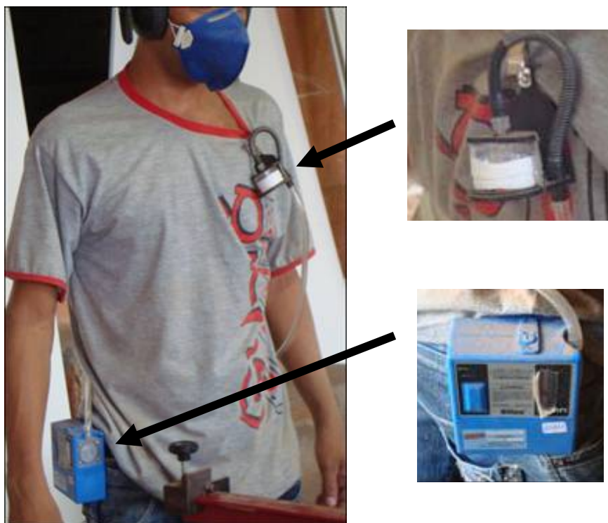
Figura 8 Configuração da coleta individual de poeiras suspensas no ar com detalhe da instalação do cassete com filtro de membrana de PVC no trabalhador e da bomba gravimétrica
