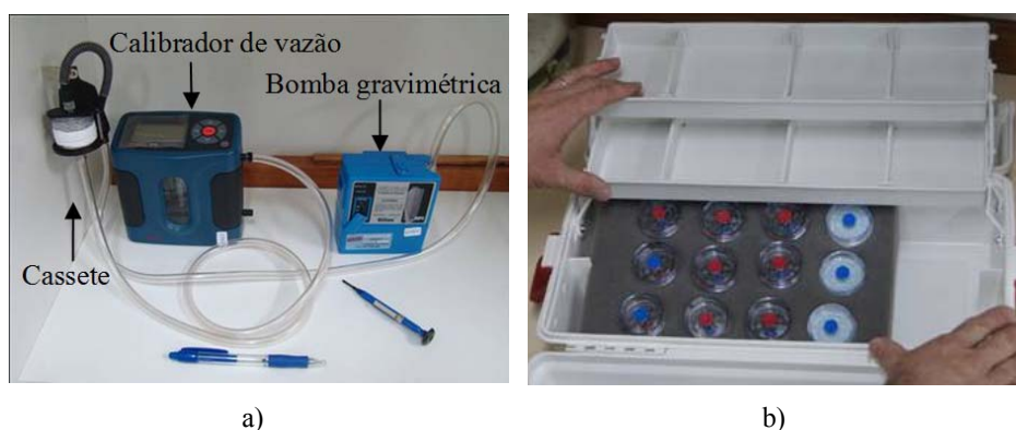
Figura 7 Calibração da vazão e do tempo de coleta dos coletores de campo, em que: a) bomba gravimétrica e calibrador de vazão; e b) acondicionamento dos cassetes para coleta de campo
