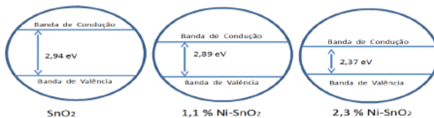
Figura 12 - Representação da diminuição do band gap dos materiais de SnO 2 dopados com Níquel.
