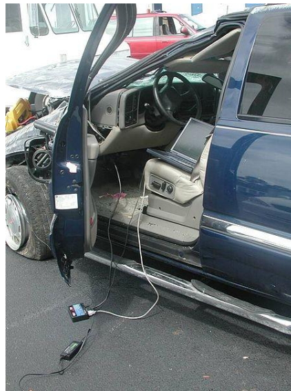
Figura 2 - Extração de dados de um EDR após acidente de trânsito.
