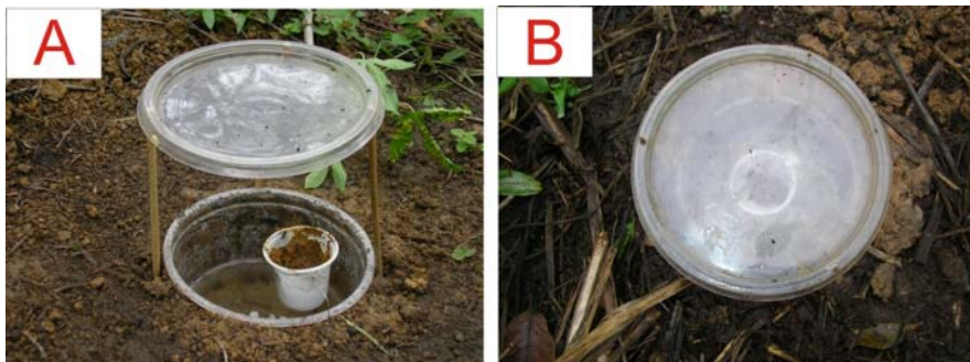
APÊNDICE B Armadilha de pitfall, utilizada, em Benjamin Constant, Am, Brasil. Vista frontal (A), Vista de cima (B)
