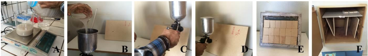
Figura 32 - A) ajuste da concentração; B) enchimento do reservatório; C e D) aspersão; E) amostras dos painéis por tratamento pulverizadas; F) estufa para secagem.
