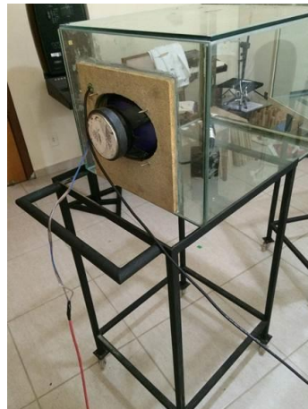
Figura 38 - Fixação do alto-falante em base de madeira na câmara emissora.
