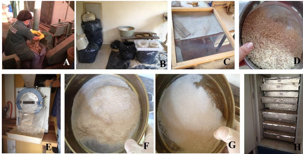
Figura 24 - A) moinho de martelo; B) partículas a peneirar; C) peneira de 8mm; D) peneira de 40mesh; E) moinho de disco; F) peneira de 60 mesh; G) pó; H) partículas na estufa.
