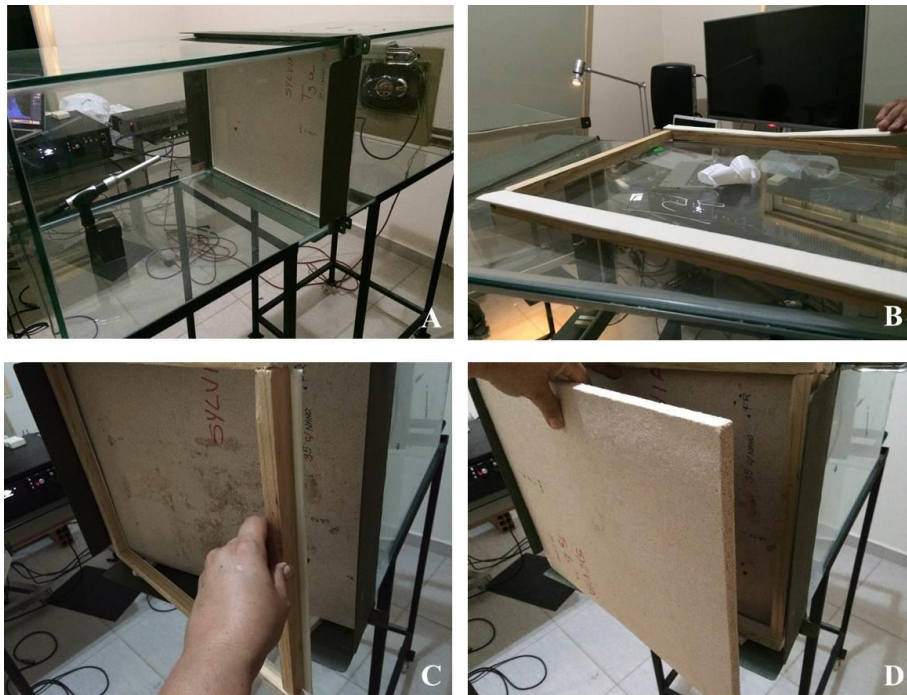
Figura 40 - (A) montagem com painel simples, 3 meios; (B) caixilho vazado separador da camada de ar, 5 meios; (C) e (D) montagem dos cinco meios.
