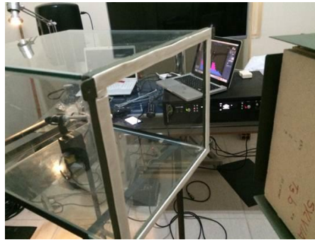
Figura 39 - Detalhe da proteção e delimitação das bordas das câmaras.
