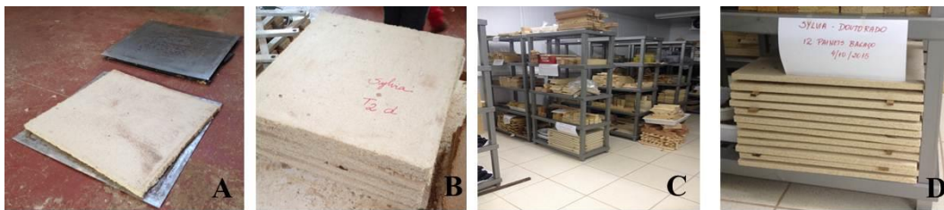
Figura 27 - A) painel saído da prensa; B) painéis a serem cortados; C e D) painéis prontos na câmara de climatização.
