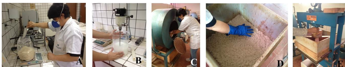
Figura 25 - A) pesagem das partículas; B) preparação do adesivo; c) mistura partícula/ adesivo na encoladeira; D) formação do colchão de partículas; E) pré-prensagem manual.
