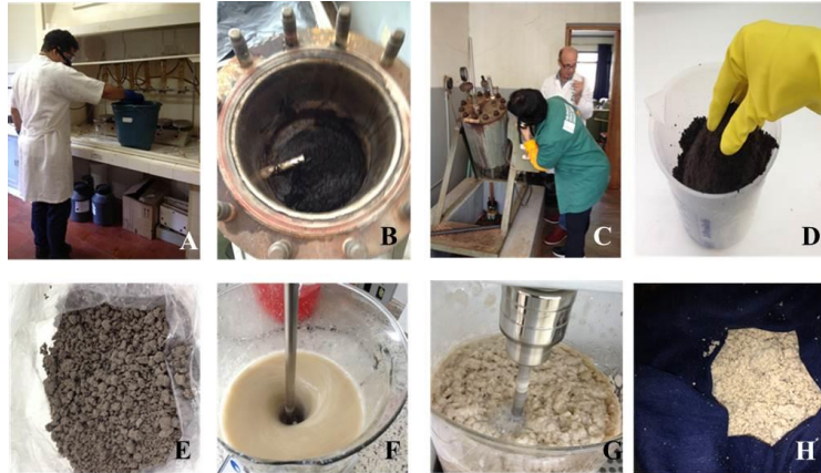
Figura 28 - A) deslignificação; B) biodigestor; C) cozimento; D) polpa escura úmida; E) polpa escura seca; F) solução para o branqueamento; G) aquecimento; H) polpa clareada.
