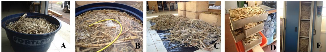
Figura 23 - A) bagaço in natura ; B) lavagem; C) secagem ao ar livre; D e E) secagem em estufa.
