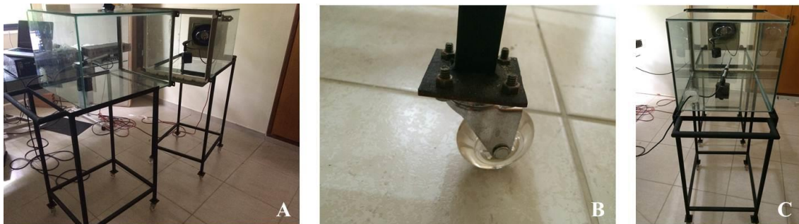
Figura 45 - (A) Apoio deslizante de ferro; (B) Rodízios de silicone; (C) Conjunto montado.
