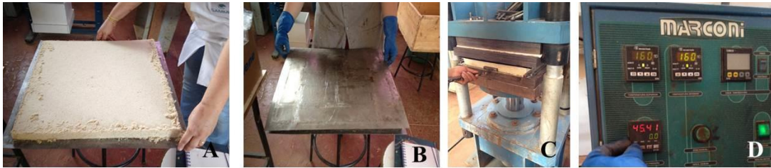
Figura 26 - A) bolo de partículas; B) limitação da espessura e cobertura; C) prensagem a quente; D) parâmetros de prensagem.
