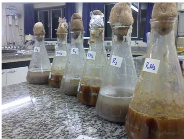
Figura 5 Mosto de fermentação após esterilização e adição do inóculo
