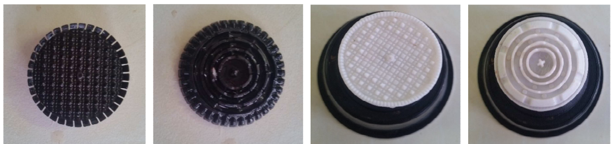
Figura 3.6 – Discos internos presentes nas cápsulas de plástico.
