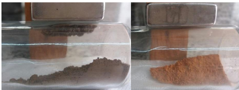
Figura 15 Ilustração da evidência de magnetização dos materiais.
