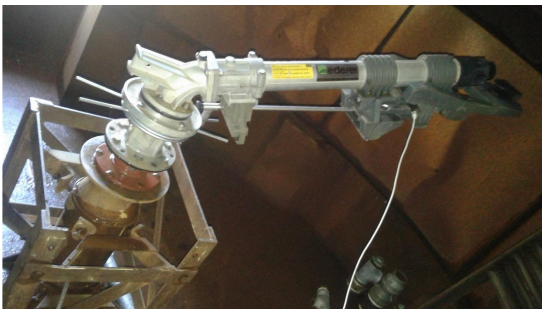
Figura 5. Aspersor Komet Twin 202 Pro instalado na campânula de ensaios.
