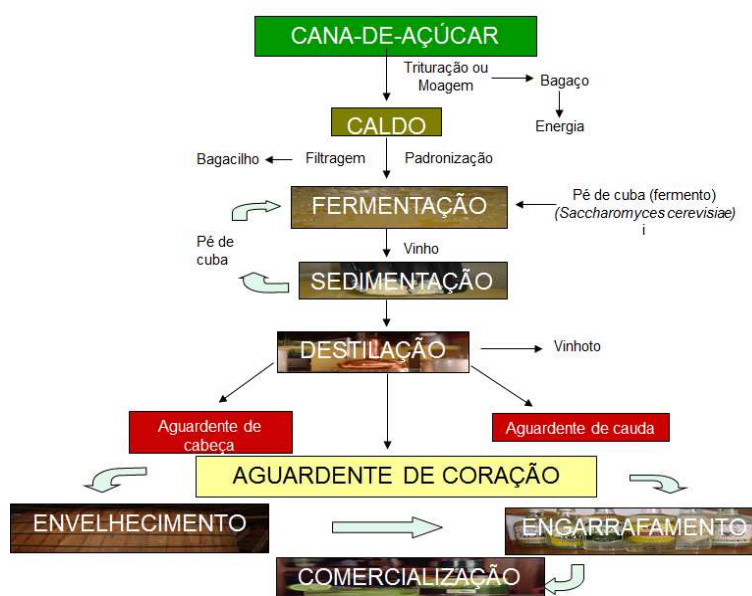
Figura 5. Fluxograma do processo de produção de aguardente/cachaça.
