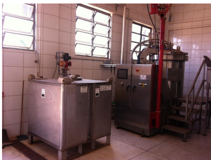
Figura 1 - Vista geral do container de depósito do hidróxido de potássio e do digestor de carcaças (A); caldeira geradora do vapor destinado ao aquecimento do digestor (B); e vista do container de depósito do substrato do digestor (C), instalados no Setor de Patologia do Departamento de Medicina Veterinária, no câmpus da Universidade Federal de Lavras.
