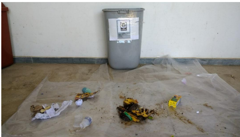
Figura 40 - Segregação dos resíduos sólidos dispostos no coletor (“bombona”) de resíduos não recicláveis, localizada na Diretoria de Extensão, para a quarta composição gravimétrica.
