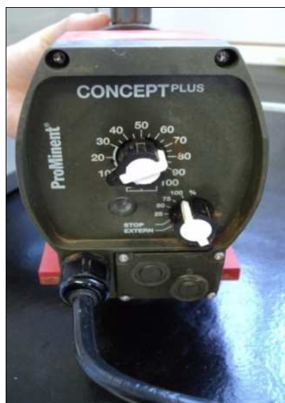
Figura 9 Vista frontal da bomba utilizada para recalque do efluente da suinocultura.
