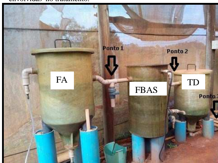
Figura 5 Vista geral do sistema de tratamento mostrando da esquerda para direita: FA, FBAS e Tanque de decantação (TD) tipo Dortmund, e os respectivos pontos de amostragem.
