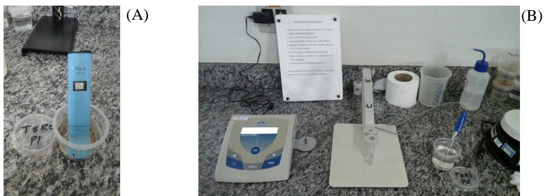
Figura 7 - Análise de condutividade elétrica (A) e de pH (B) na solução drenada dos vasos.
