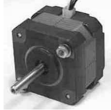
Figura 5 –Motor de Passo (KP4M4-001) utilizado no Projeto
