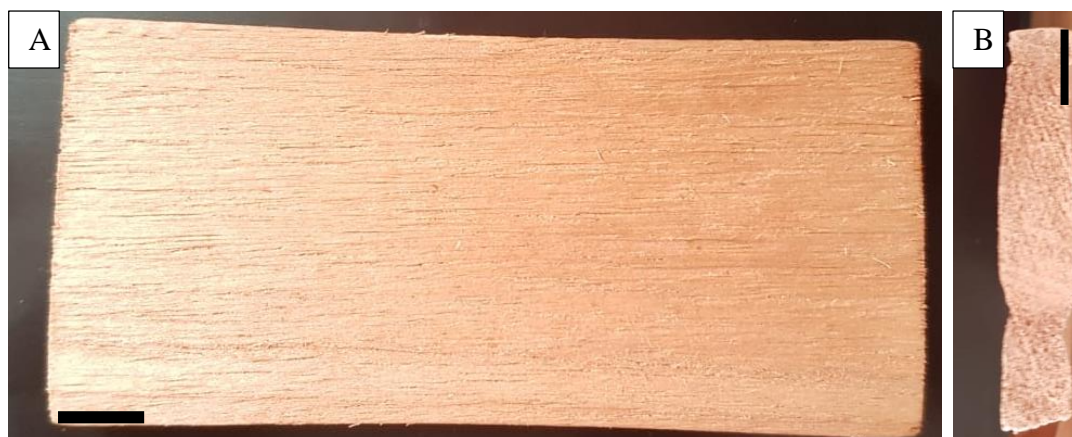
Figura 9 – Corpo de prova da madeira de Toona ciliata aos sete anos de idade após a secagem drástica a 100°C. A = corpo de prova com ausência de rachadura e B = topo do corpo de prova com colapso. Barra = 1cm.
