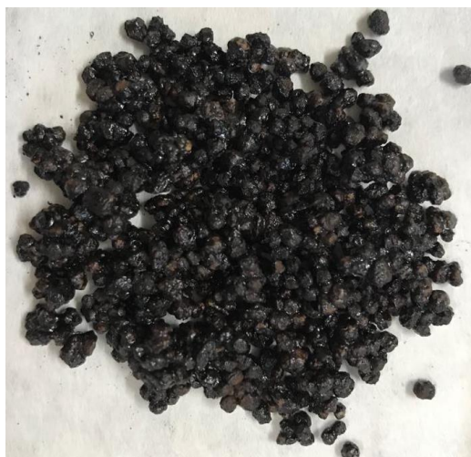
Figura 7 – Grânulos de fertilizante revestidos e secos.
