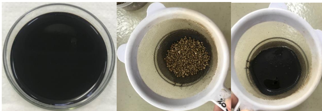
Figura 6 – Imersão dos grânulos de fertilizante em solução de revestimento.
