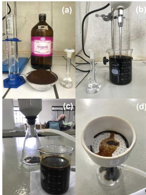
Figura 5 - Preparo das suspensões de lignina kraft.
