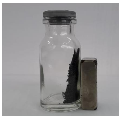
Figura 24 - Esferas QSF e atraídas por um ímã.
