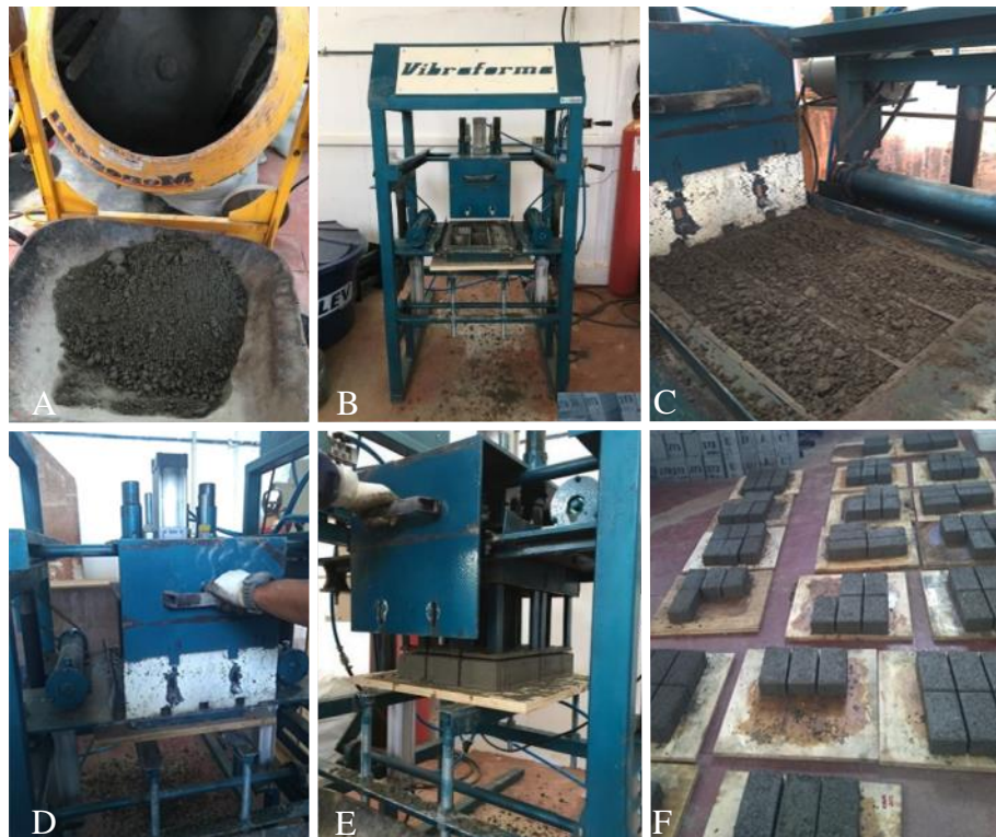
Figura 1 – Processo de fabricação dos pavers .
