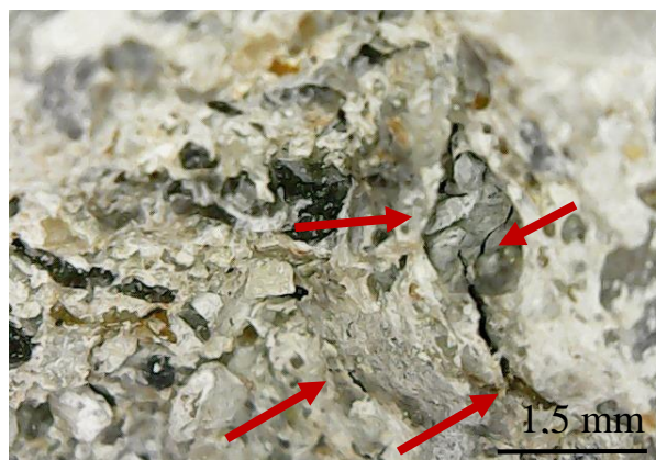
Figura 20 – Micrografia mostrando microtrincas presentes nos pavers com a inclusão de cinzas da casca de arroz.
