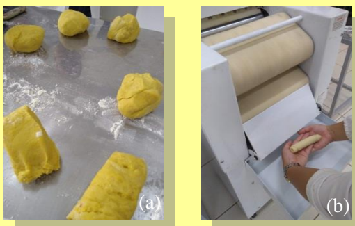
Figura 6. (a) Etapa de divisão e boleamento da massa; (b) Etapa de modelagem da massa utilizando uma modeladora de escala laboratorial.
