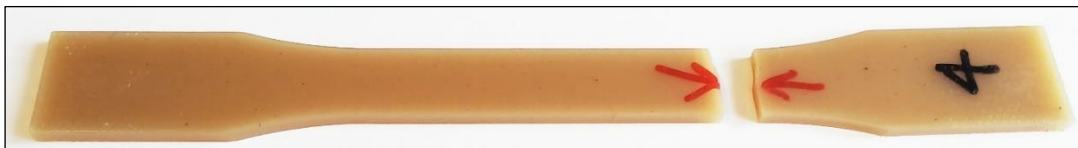
Figura 24 – Imagem da ruptura de um corpo de prova do compósito PLANFC40/6 durante o ensaio de tração.
