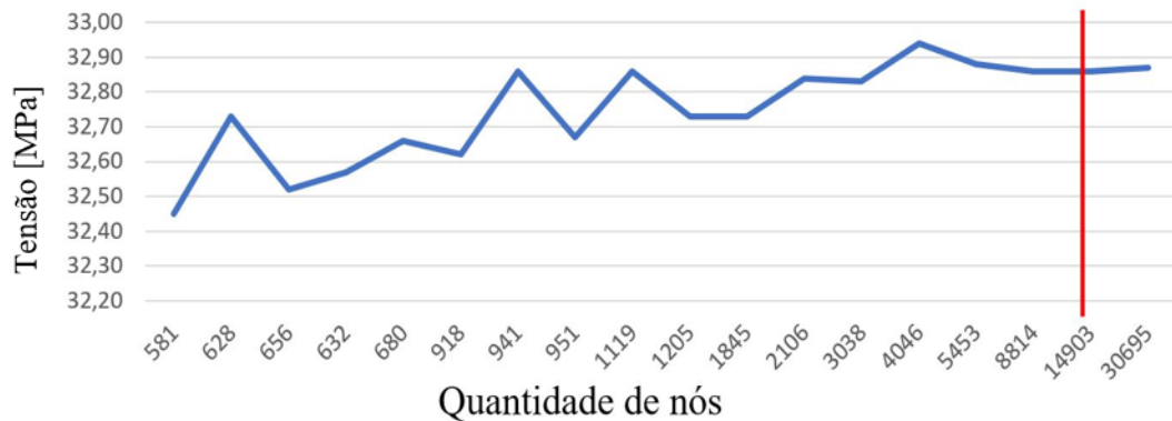
Figura 22 – Valores obtidos durante convergência de malha do corpo de prova de tração em função da quantidade de nós.
