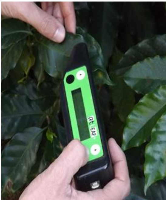
Figura 10 – Clorofilômetro utilizado para medir o teor de clorofila nas folhas do cafeeiro.
