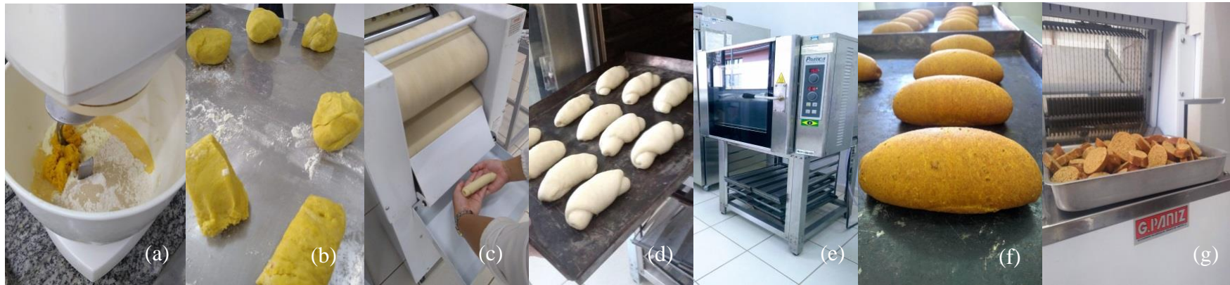
Figura 4 - Etapas do processo de fabricação dos pães doces de pequi e de gabioba. (a) etapa de mistura dos ingredientes, (b) divisão e boleamento da massa, (c) modelagem da massa; (d) massa após a etapa de fermentação; (e) etapa de forneamento; (f) resfriamento a temperatura ambiente; (g) etapa de fatiamento dos pães.
