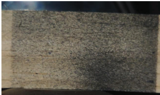
FIGURA 3 Corpo de prova de madeira de Pinus Taeda pigmentado com tinta preta. Fonte: Acervo pessoal.
