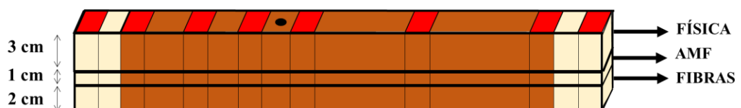
Figura 6 – Representação da retirada das amostras para testes físicos, AMF e biometria das fibras
