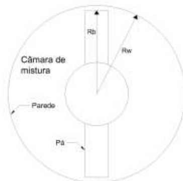
Figura 4. 5: Representação esquemática da seção transversal da câmara do misturador Gelimat.
