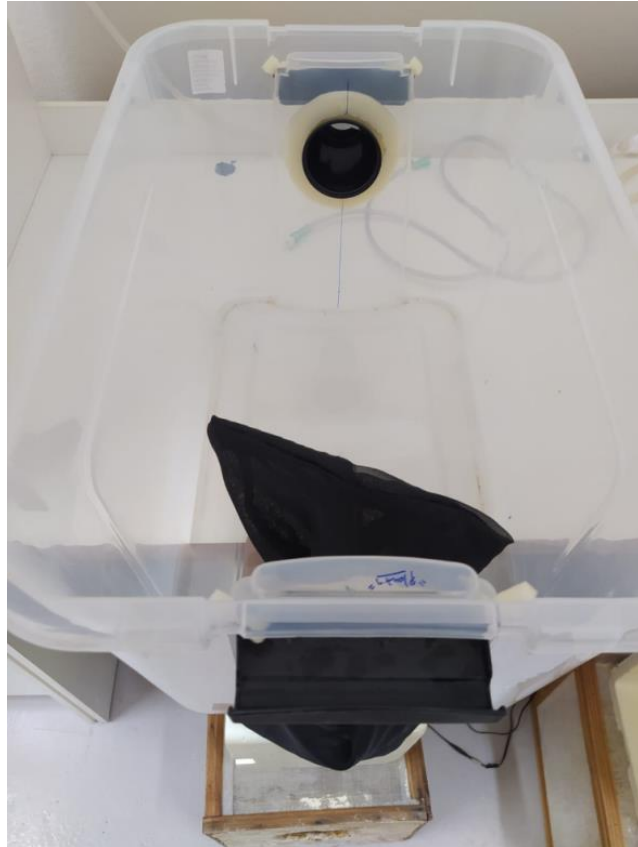
Figura 1- Sistema de avaliação de estímulos olfativos através da adaptação do túnel de vento.
