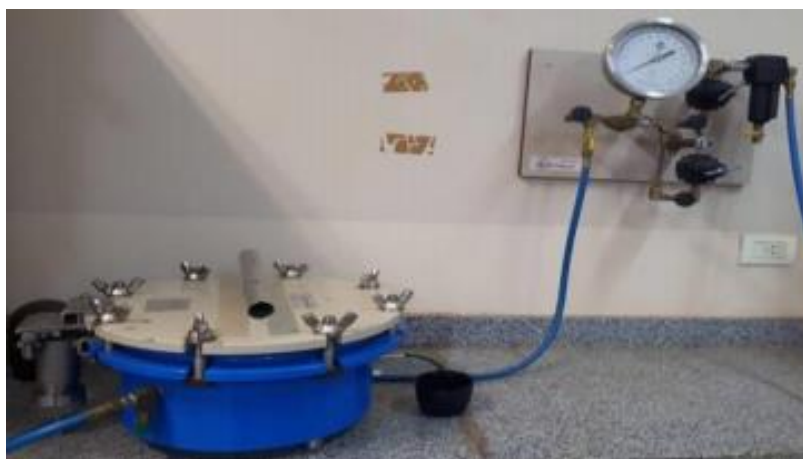
Figura 4 - Câmara de pressão de Richards.
