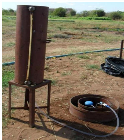
Figura 1 - Infiltrômetro de anéis concêntricos em campo.
