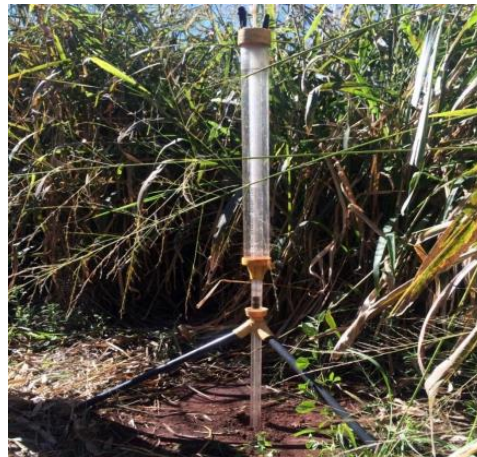
Figura 2 - Permeâmetro de Guelph instalado em campo.
