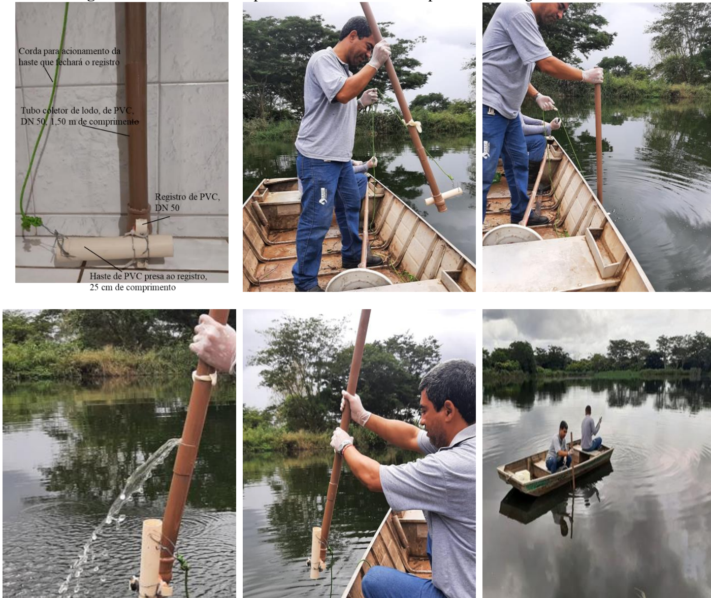
Figura 12 - Detalhes do dispositivo de coleta e das etapas de amostragem de lodo.
