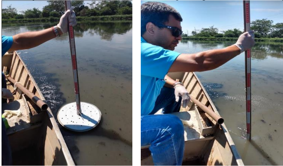
Figura 8 - Medição da altura da camada de lodo na lagoa de polimento, ETE/Pirapora.
