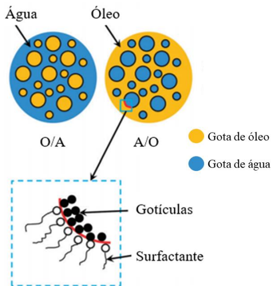
Figura 11 - Emulsão concentrada de óleo em água e emulsão concentrada de água em óleo, com destaque para o surfactante
